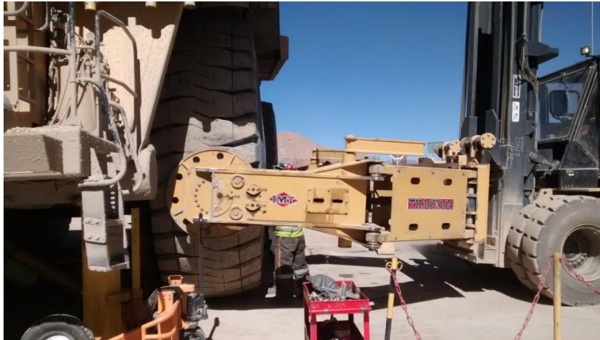
Figura 6.11 Retiro de tuercas que aseguran la rueda.
