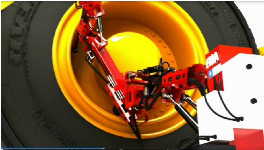
Figura 6.25 Sistema extractor de tuercas en funcionamiento.
