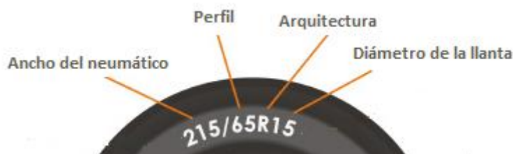
Figura 6.9 Nomenclatura de neumáticos.
