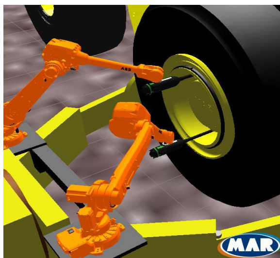
Figura 6.17 el sistema instala o retira automáticamente las tuercas.
