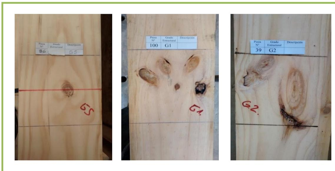
**Figura 6: Ejemplo piezas de madera clasificadas en forma visual.**
