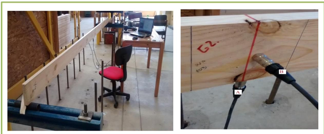
Figura 9: Ensayo vibraciones transversales (h).
