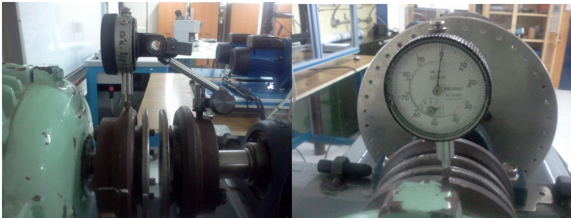
Figura 6.2. Posición de indicador de carátula para lectura de valores RIM, ajuste de aguja a valor cero en 0°.
