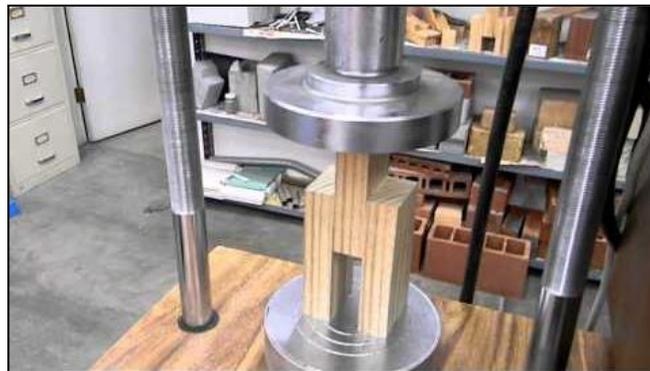
Figura 1: Ensayo De Cizallamiento
