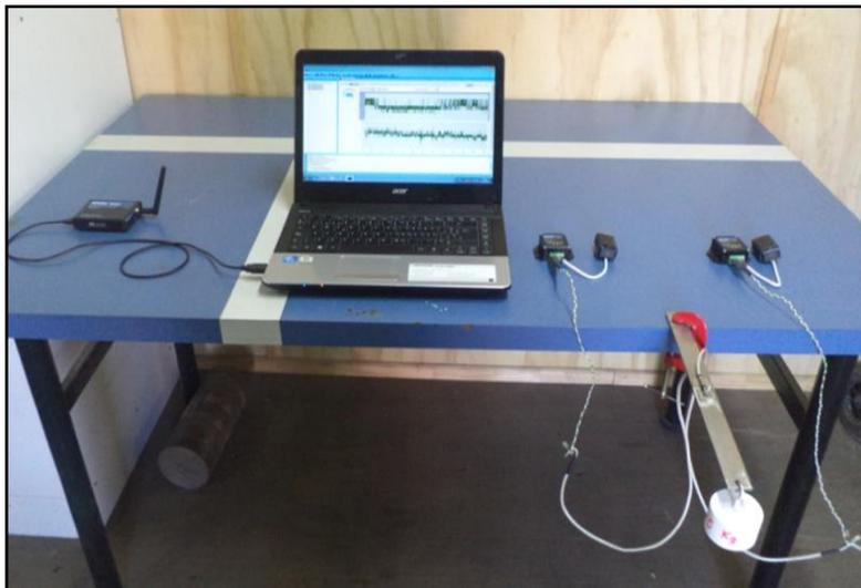
Figura 35: Barra Instrumentada Con Nodos Micro Strain
