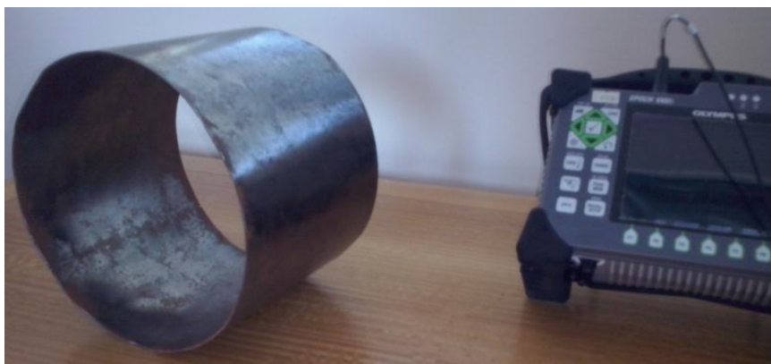
Fig. 4.1. Sección de tubería y equipo de ultrasonido en laboratorio
