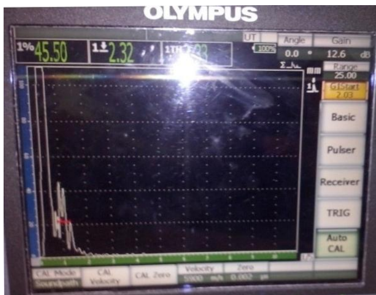
Fig.4.4. Medición de espesor utilizando ultrasonido 35 .
