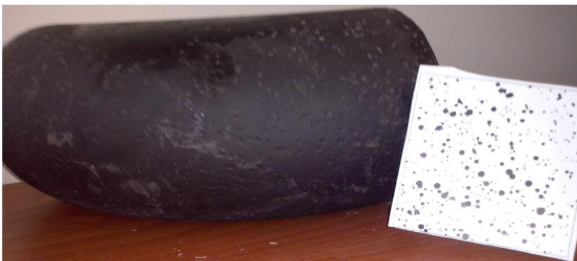
Fig.4.11. Codo con pitting exterior y figura representativa
