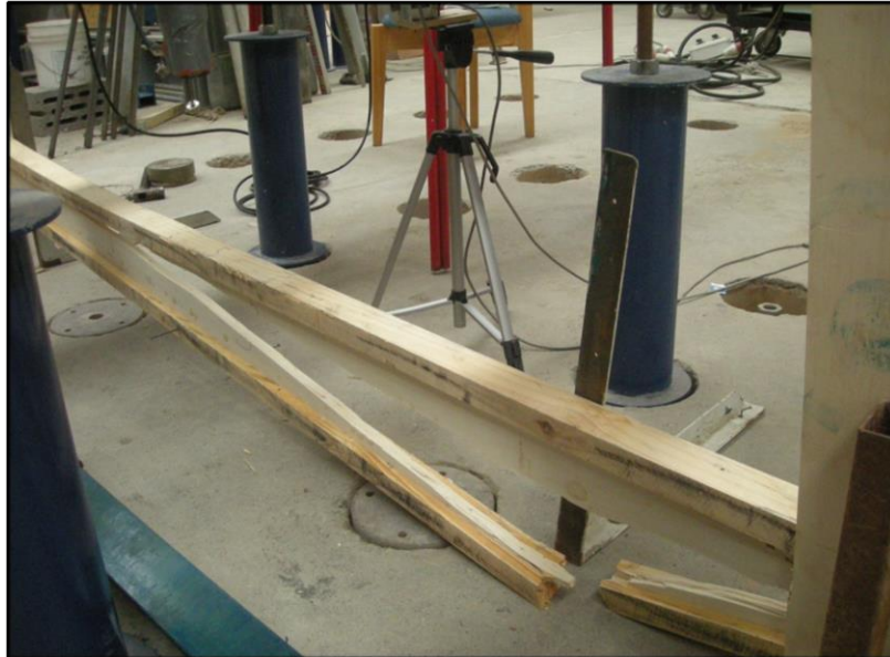
Figura L3: Falla por fractura total (falla primaria).
