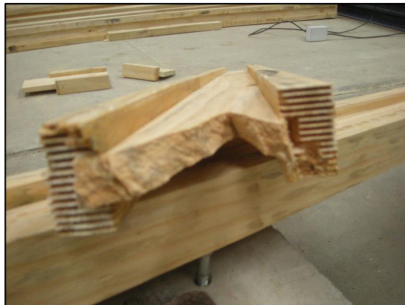
Figura L6: Unión finger-joint ala inferior (falla primaria) y superior (falla secundaria).
