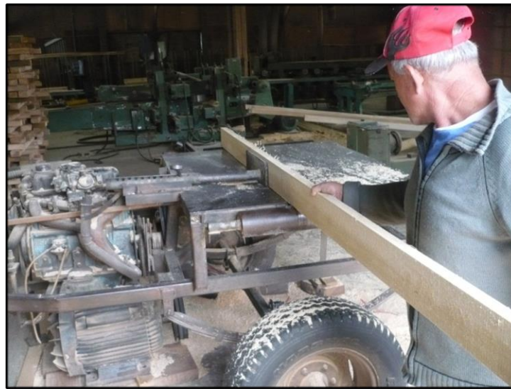
Figura B6: Dimensionamiento con sierra canteadora (frontal).
