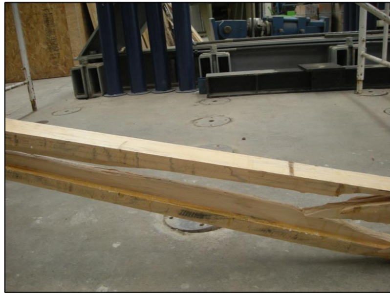
Figura L12: Falla por fractura total (falla primaria).
