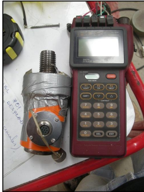
Figura A3: Celda de carga y medidor electrónico.
