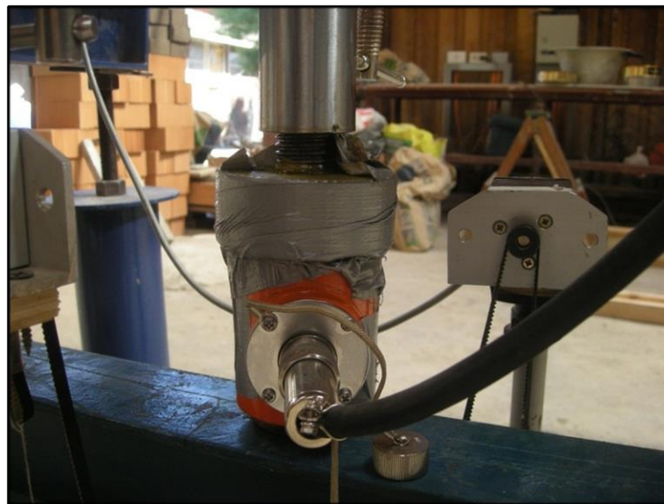
Figura A4: Celda de carga unida al pistón hidráulico.
