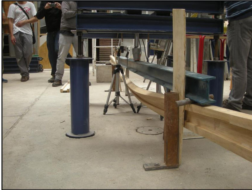
Figura L17: Alabeo antes de la fractura total.
