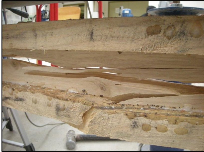
Figura L33: Falla por nudo en el ala inferior (falla primaria).
