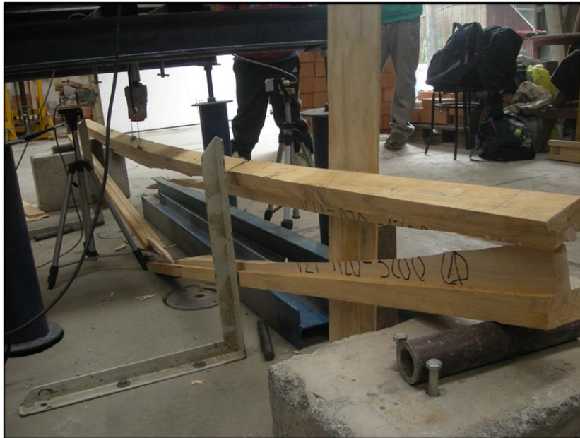
Figura L32: Falla por fractura total (falla primaria).
