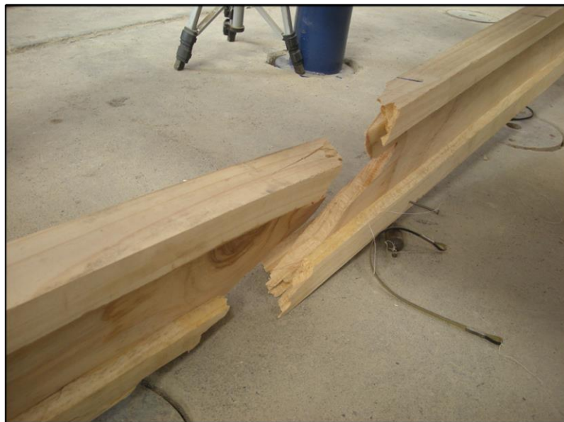
Figura L2: Falla por fractura total (falla primaria).
