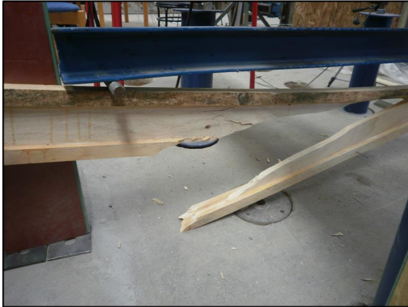
Figura L27: Falla por nudo en el ala inferior (falla primaria).
