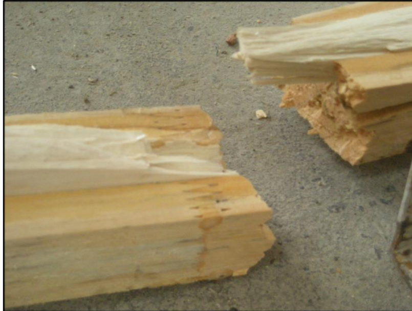
Figura L4: Falla por fractura total (falla primaria).
