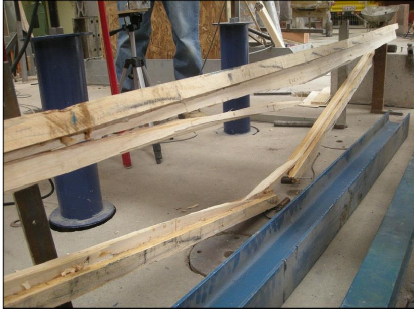
Figura L31: Falla por fractura total (falla primaria).
