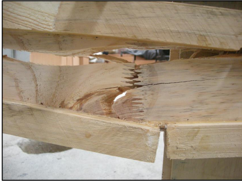
Figura L19: Falla por nudo en el alma (falla primaria).
