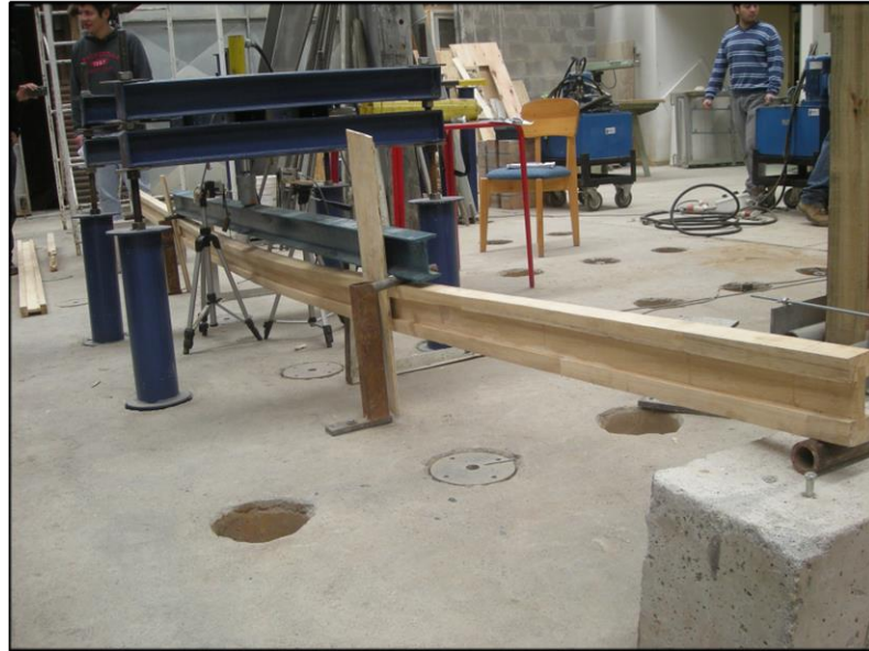
Figura L13: Alabeo antes de la fractura total.
