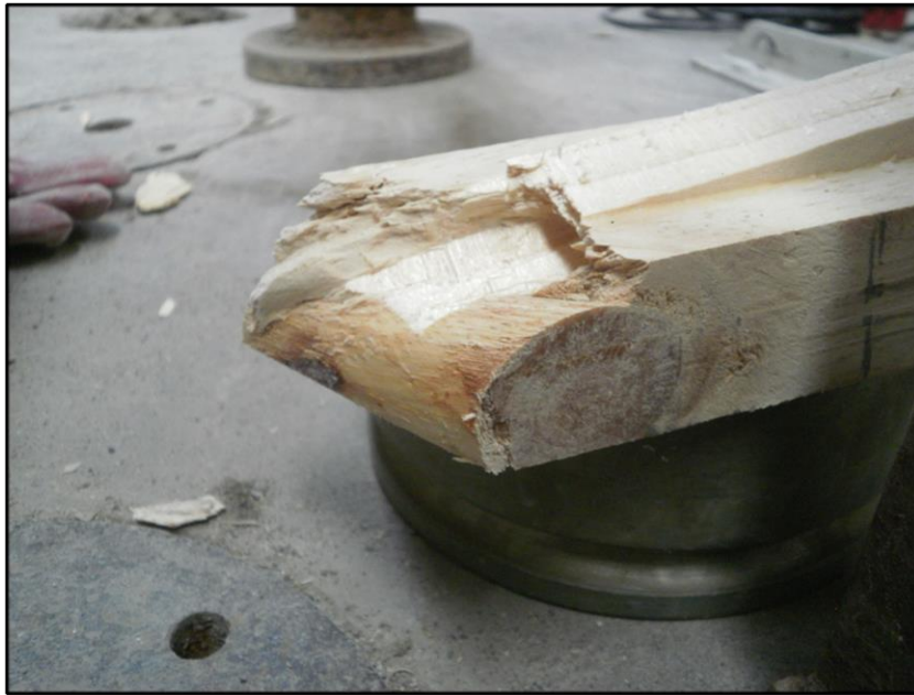
Figura L29: Falla por nudo en el ala inferior (falla primaria).
