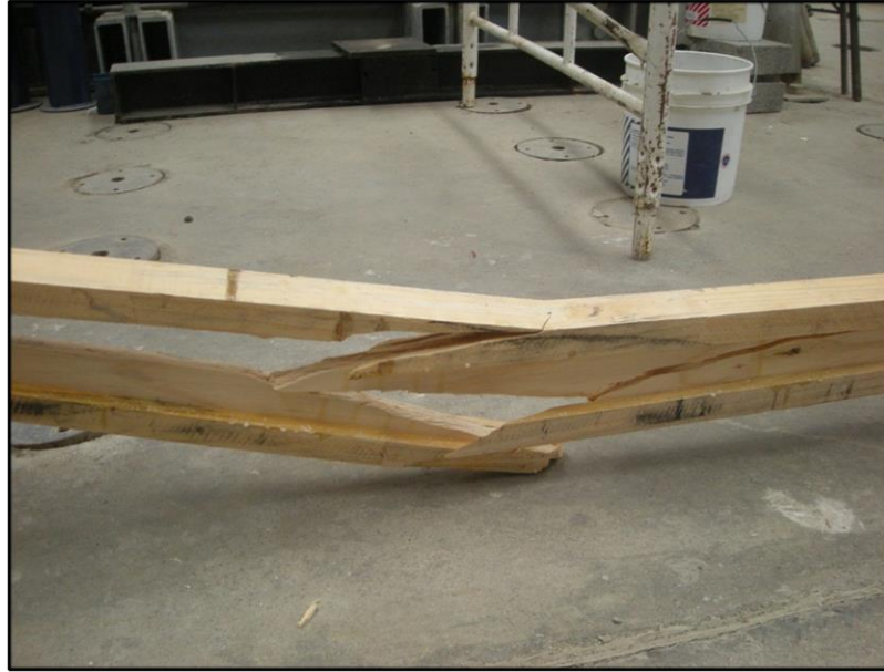
Figura L11: Falla por fractura total (falla primaria).
