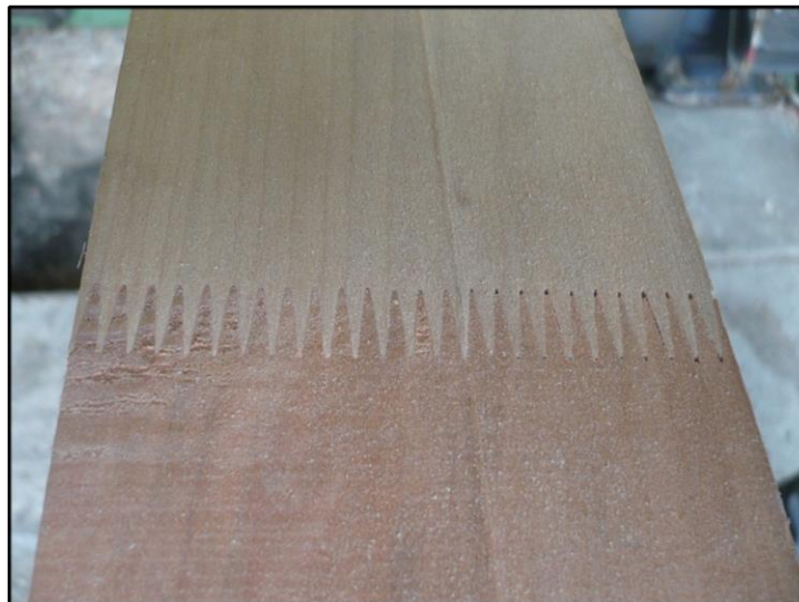
Figura B12: Unión finger-joint finalizada.
