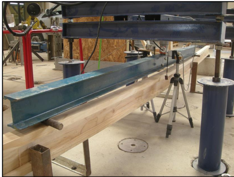
Figura L1: Alabeo antes de la fractura total.
