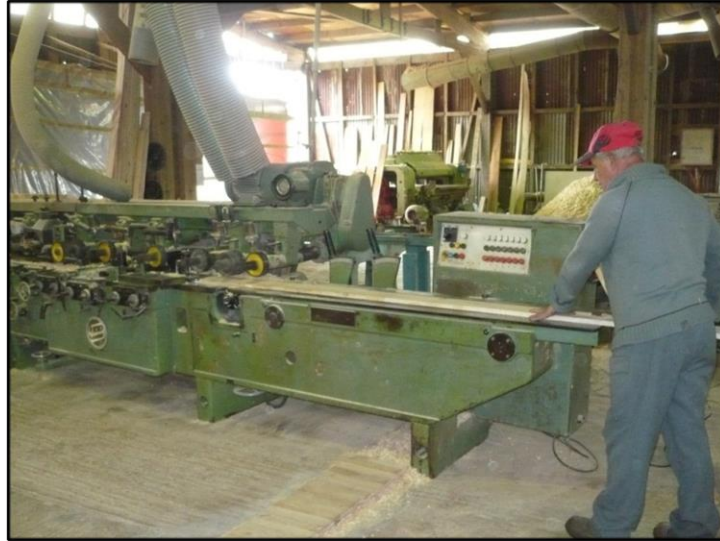
Figura B13: Moldurera para cepillar las alas y almas.
