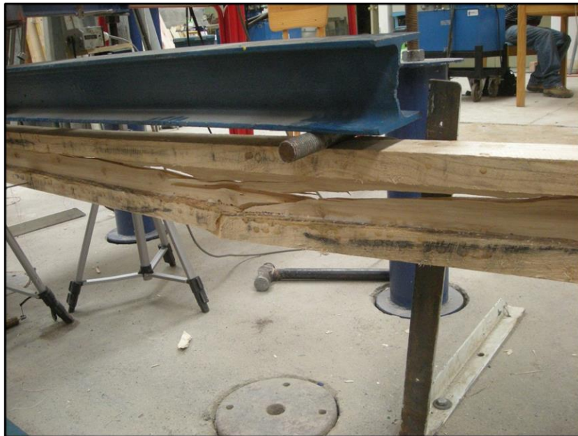
Figura L34: Falla por nudo en el ala inferior (falla primaria).
