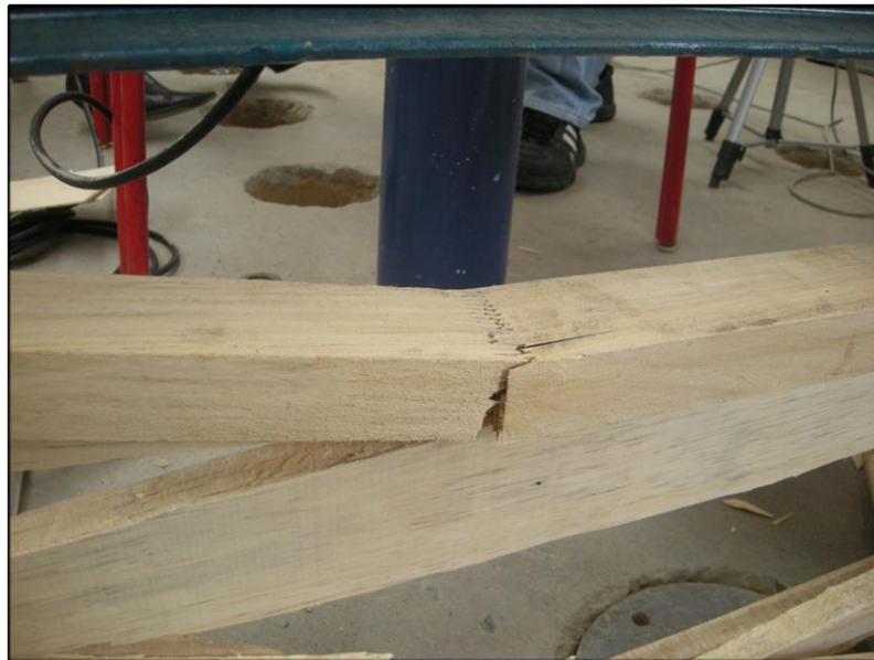
Figura L10: Falla de la unión finger-joint ala superior (falla primaria).
