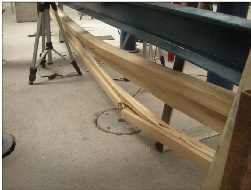
Figura L18: Falla por fractura total (falla primaria).
