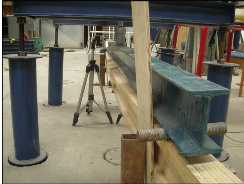
Figura L7: Alabeo antes de la fractura total.
