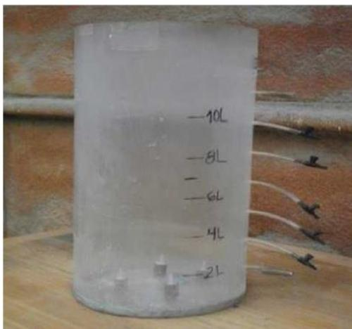
**Figura B.1: Tanque de aireación.**
