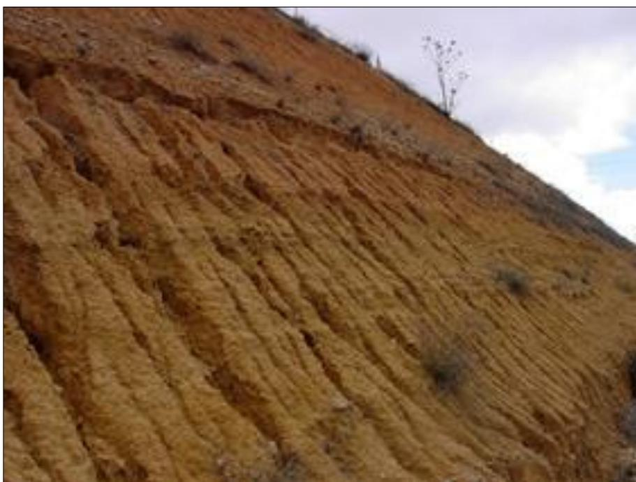
**Figura C.2. Erosión en surcos**
