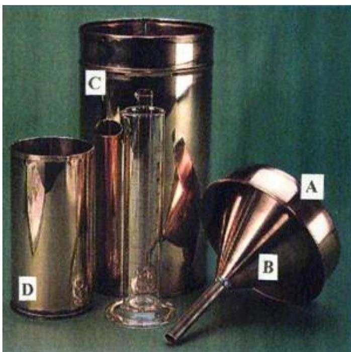
**Figura B.7. Pluviómetro ordinario.**
