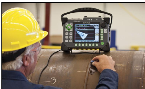
Figura 2.1 Inspeccion por ultrasonido con equipo EPOCH 1000i
