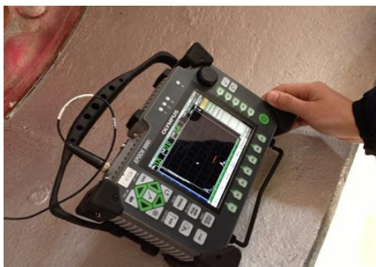
Figura 9.1 Midiendo en placa de caldera
