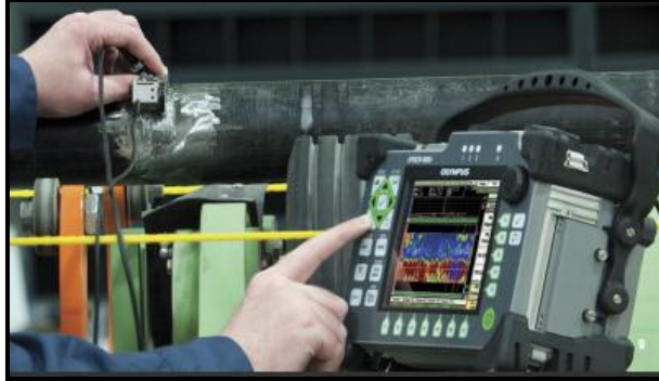
Figura 1.4 Inspección por método de ultrasonido
