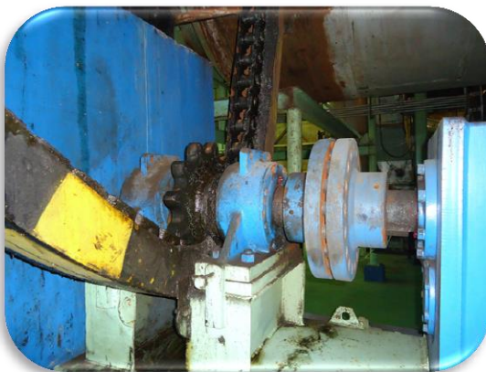
Figura 4.6 Piñón Z=12, Acoplamiento rígido, caja reductora.-
