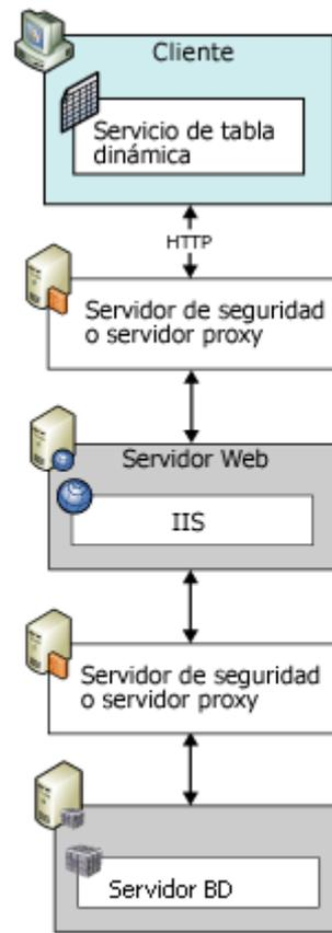
Figura 2.4 Configuración de los equipos de la red.
