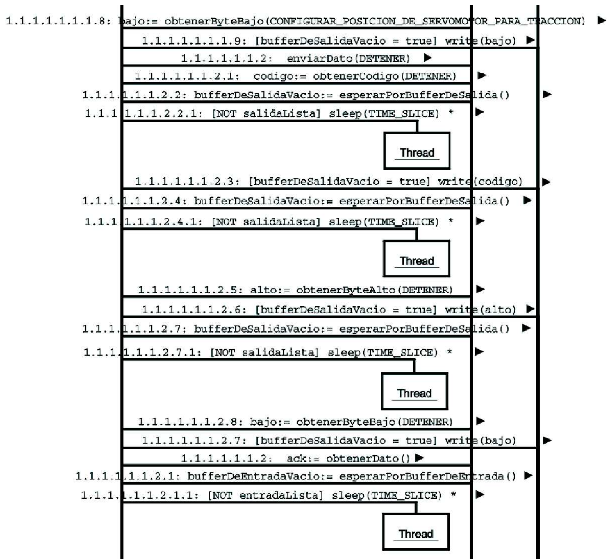
Figura 3-80. Diagrama de Colaboración detener agente inteligente, segunda parte.
