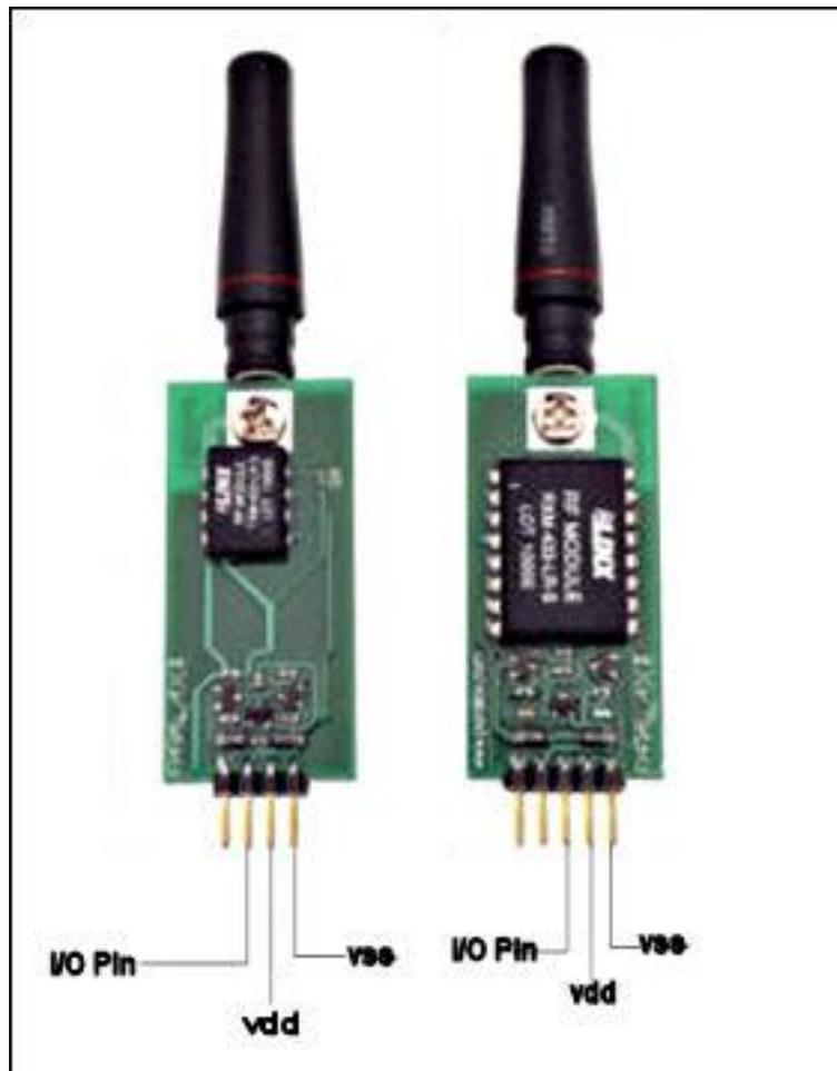
Figura 4.15: El circuito del transmisor a la izquierda y a la derecha el circuito del receptor.
