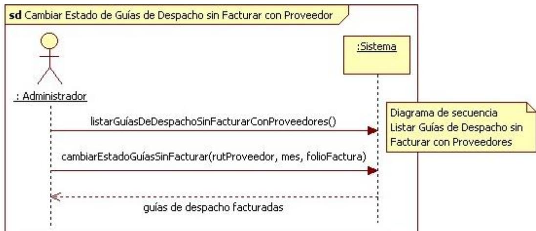
**Figura 6.24.** Diagrama de secuencia Cambiar Estado de Guías de Despacho sin Facturar con Proveedor (Caso de Uso “Cambiar Estado de Guías de Despacho sin Facturar con Proveedor”, Tabla 6.17).
