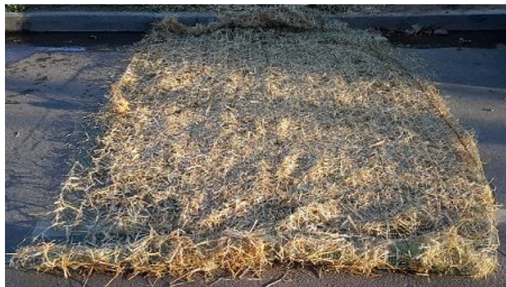
Figura 4: Biomanto en base a paja de trigo y filamentos de polietileno. (Fuente: Elaboración propia.)
