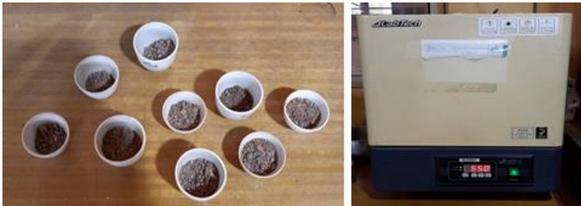
Figura D9:Muestras en crisoles y mufla en funcionamiento.
