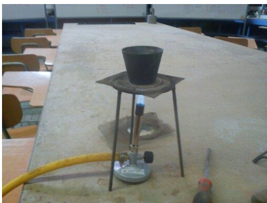
Figura B.4.1 Quemador – mufla
