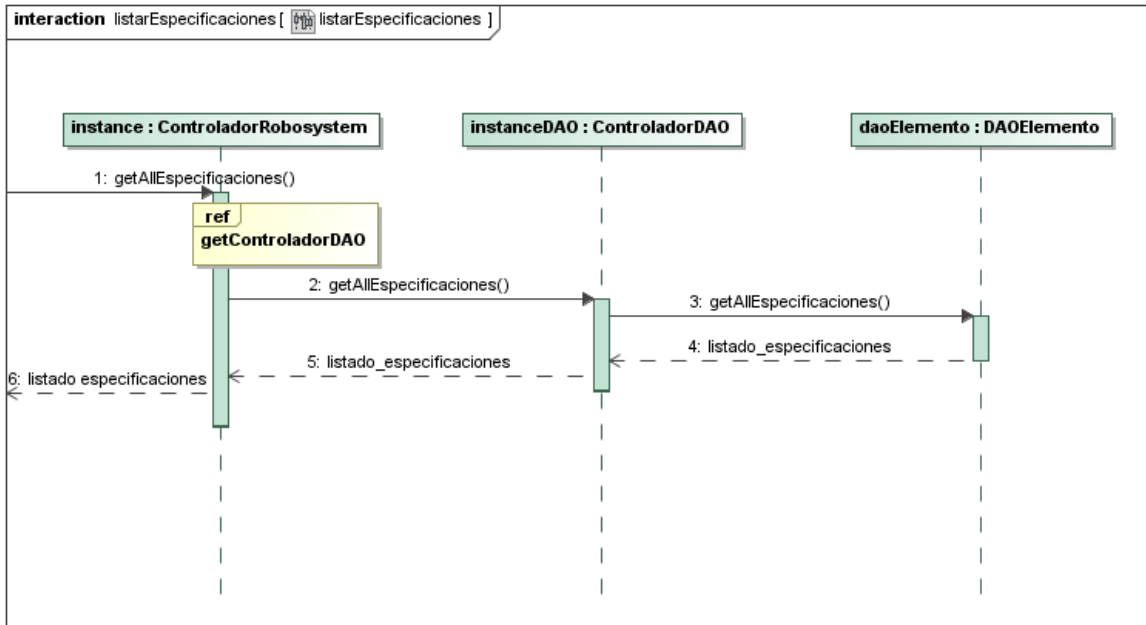
Figura 48 Secuencia de Listar Materiales y/o Equipos 1
