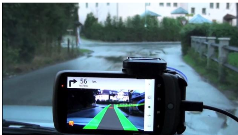
ILUSTRACIÓN 20: WIKITUDE DRIVE, UNA APLICACIÓN QUE COMBINA LA NAVEGACIÓN GPS POR CARRETERA, CON MAPAS 2D Y REALIDAD AUMENTADA
