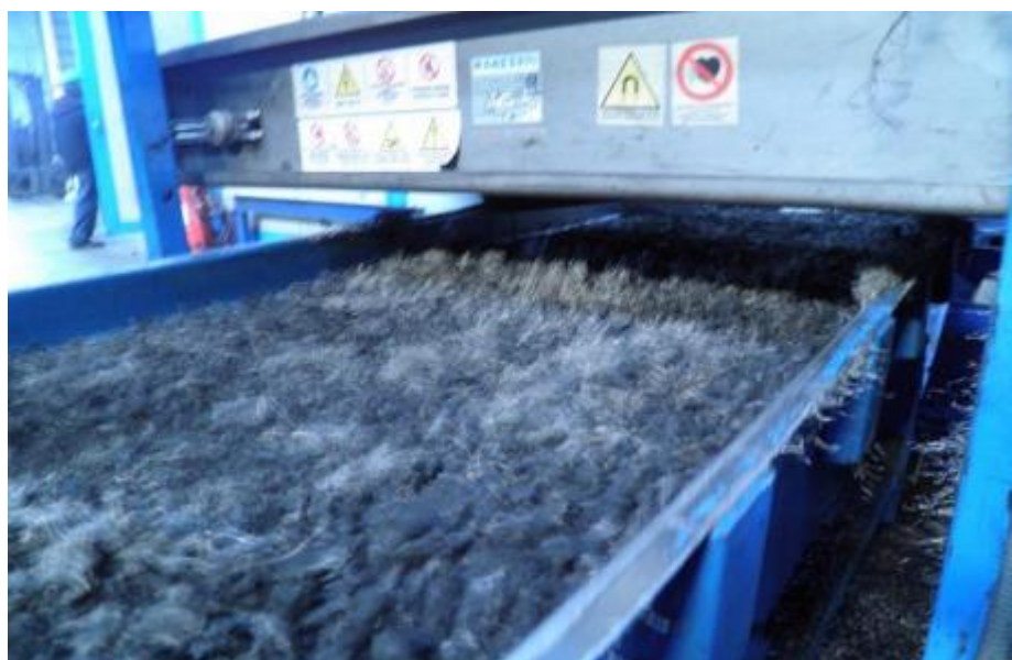
Figura 19. Separador superior por correas magnéticas. (Fuente: Cortesía de Polambiente S.A, 2014).
