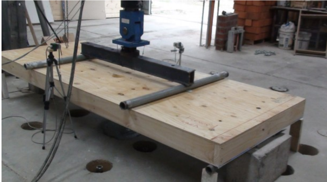
Figura C.1.2. Implementación ensayo flexión losa.
