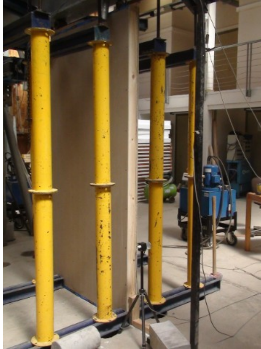
Figura C.3.2. Implementación ensayo carga horizontal muro.
