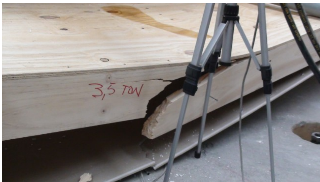
Figura C.1.3. Modo de falla típico ensayo flexión losa.
