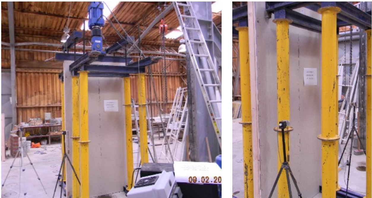
Figura C.2.2. Implementación ensayo compresión muro.
