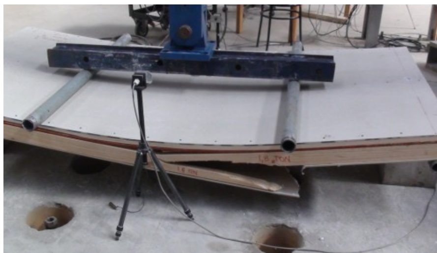
Figura C.1.5. Implementación ensayo flexión muro.
