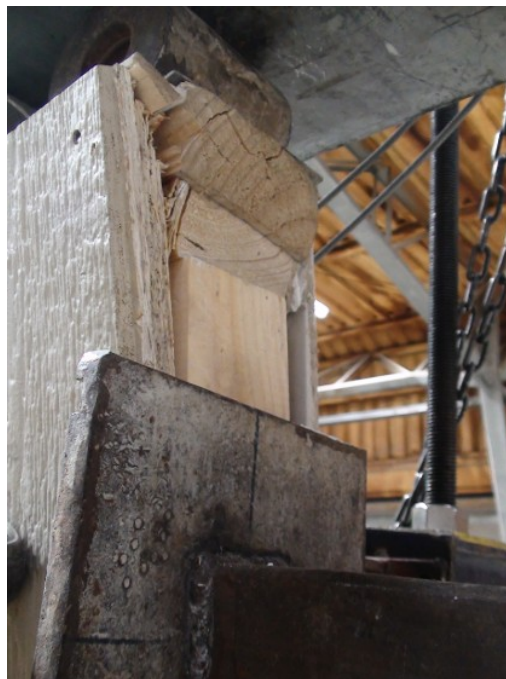
Figura C.3.3. Modo de falla típico ensayo carga horizontal muro.
