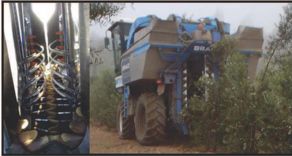
Imagen Nº 2: Sistema de vareo y vibración de una maquina cosechadora de tipo cabalgante.
