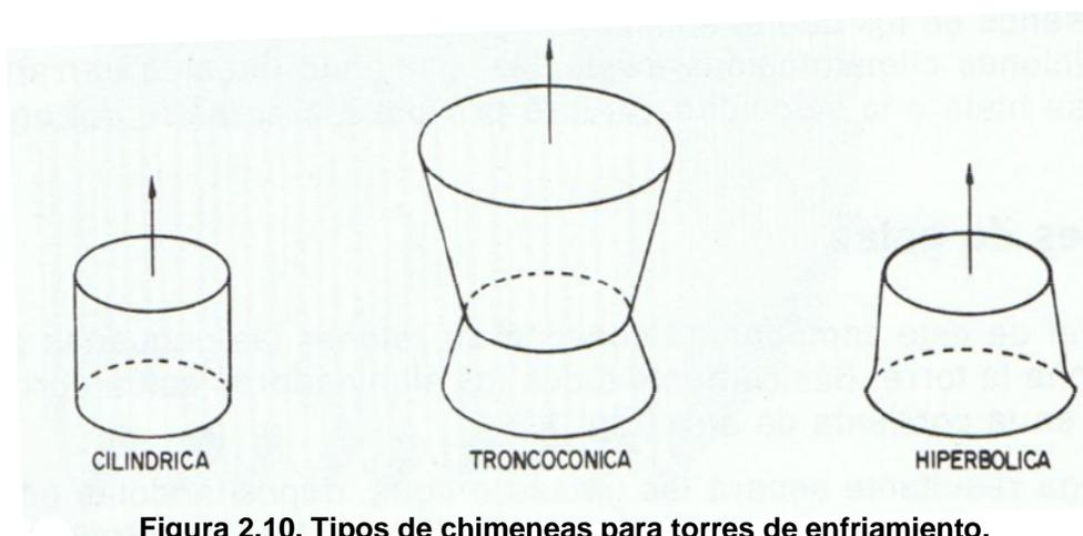
Figura 2.10. Tipos de chimeneas para torres de enfriamiento.
