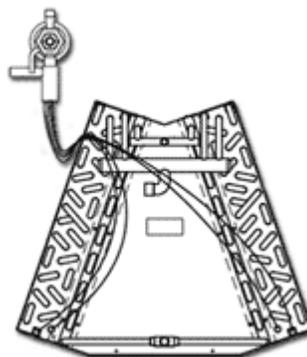
**Figura 1.6: Evaporador de doble radiador en V.**
