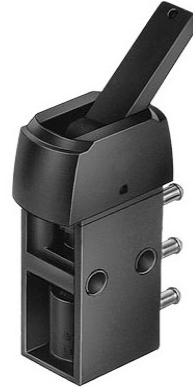
Ilustración 3 - Válvula 3/2 con activación por palanca con enclavamiento y retorno por resorte.
