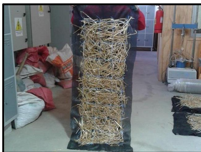
**Figura 4. Paja de trigo adherida a malla raschel mediante filamentos de polipropileno. (Fuente: Elaboración propia)**
