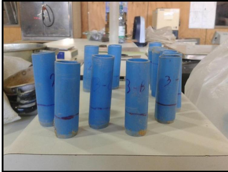
**Ilustración 6. Testigos utilizados para medir compactación en taludes experimentales.
