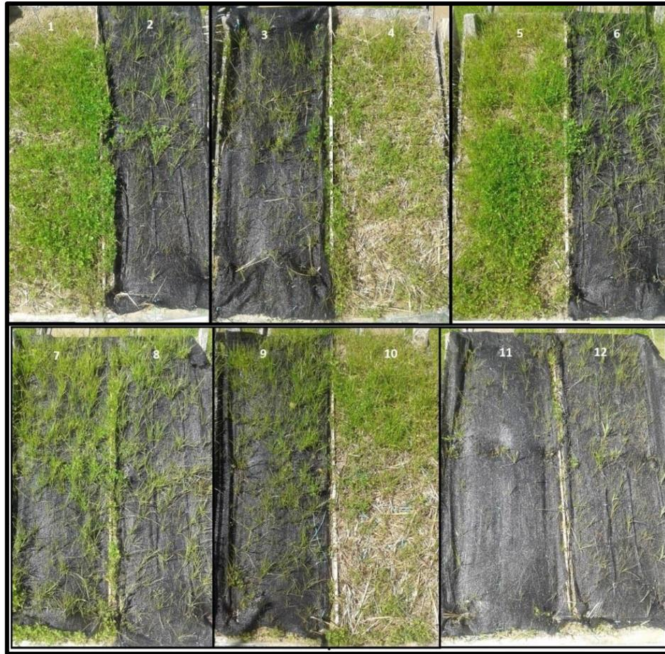
**Figura 12. Talud: 1, 8 y 12 ( $150 \text{ g/m}^2$ ); 2, 4 y 11 ( $315 \text{ g/m}^2$ ); 3, 6 y 10 ( $270 \text{ g/m}^2$ ); 5, 7 y 9 ( $0 \text{ g/m}^2$ ). (Fuente: Elaboración propia).**
