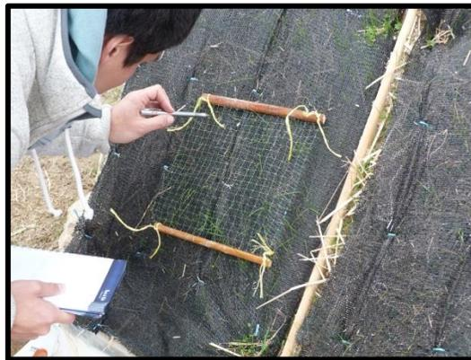
**Figura 5. Medición de cobertura vegetal a través del método del cuadrante. (Fuente: Elaboración propia)**
