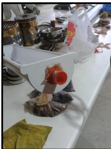
**Ilustración 5. Decantador de material erodado con filtro. (Fuente elaboración propia)**
