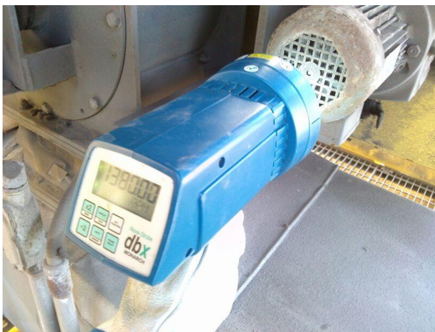
Figura N° 7.1 Medición de rpm, equipo estroboscopio portátil "Nova-Strobe".
