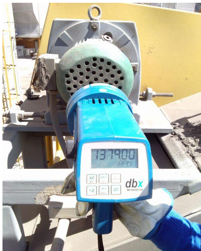
Figura N° 7.2 Medición de rpm, equipo estroboscopio portátil “Nova-Strobe”.
