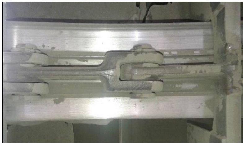
Figura N° 6.1 Desgaste de guía de retorno
