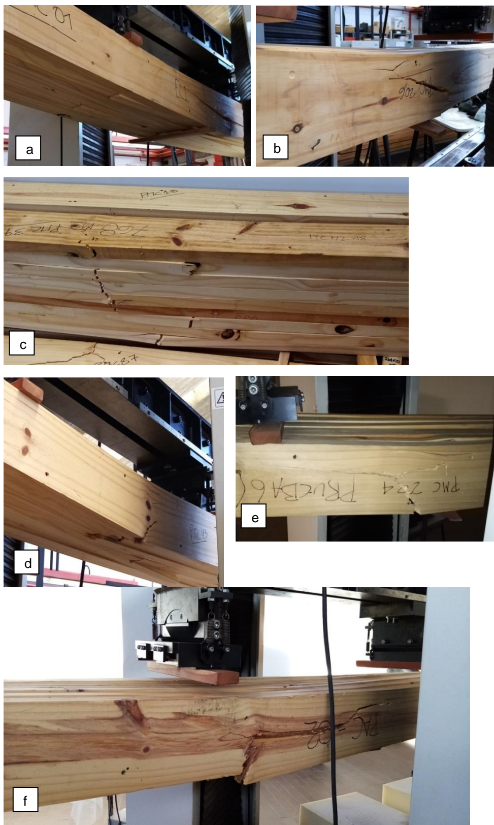
Figura 41. Diferentes modos de rotura de las placas. a) presencia de nudo b) desviación de las fibras, c) varios, d) presencia de nudo + desviación de las fibras, e) rotura de fibras sin presencia de defectos y f), presencia de médula + nudos.
