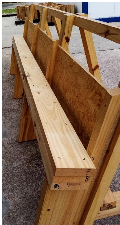
Figura 42. Caballete para armado de placas y paneles.
