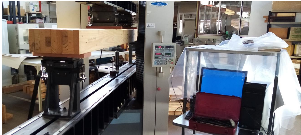
Figura 34 Configuración del ensayo a flexión de las placas de tamaño estructural
