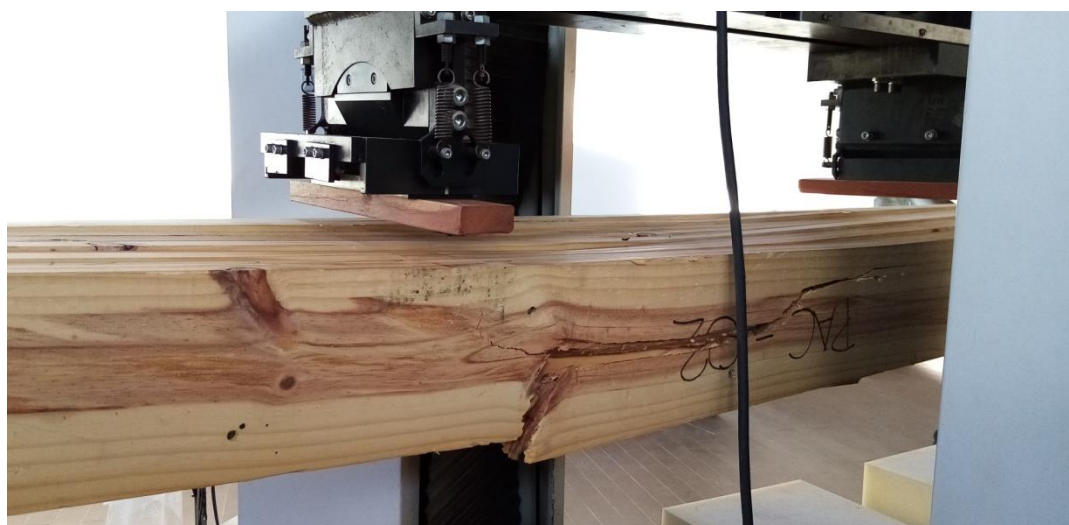
Figura 39. Placa luego de alcanzar la rotura.
