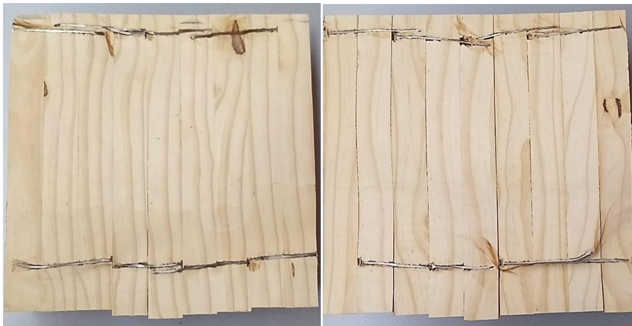
Figura 27. Deformación de los clavos luego de la aplicación de las cargas. Serie P9S.
