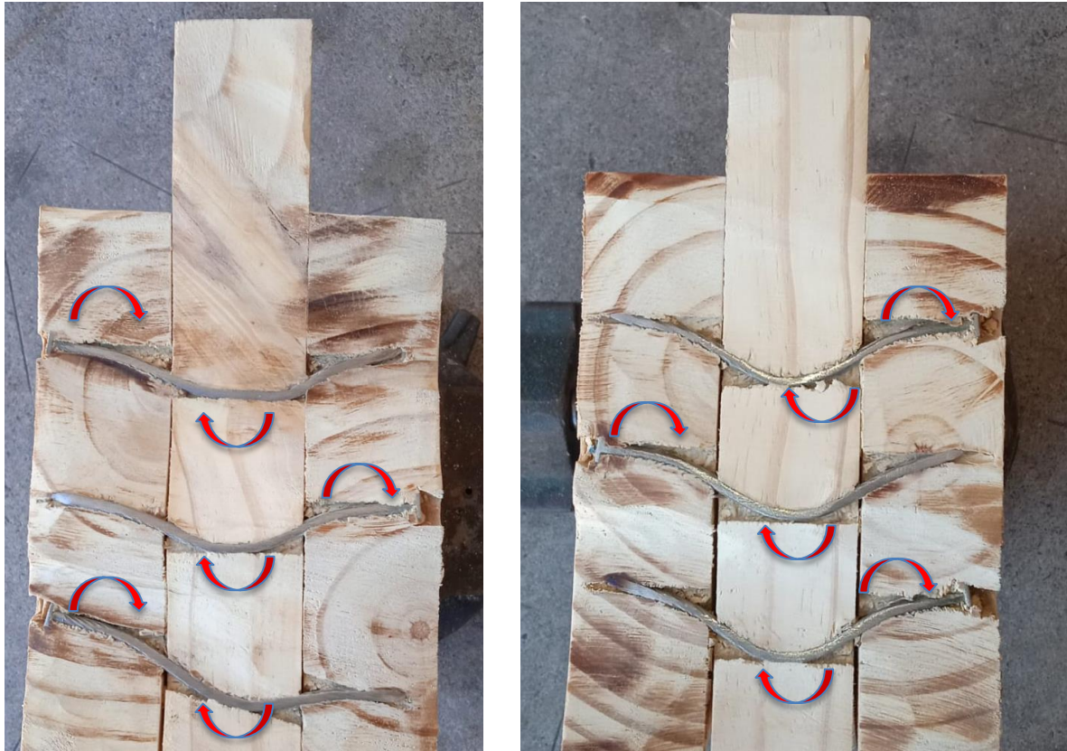
Figura 23. Piezas sometidas a cizalle doble (Serie PT35) con deformaciones de los clavos luego de ser ensayados.
