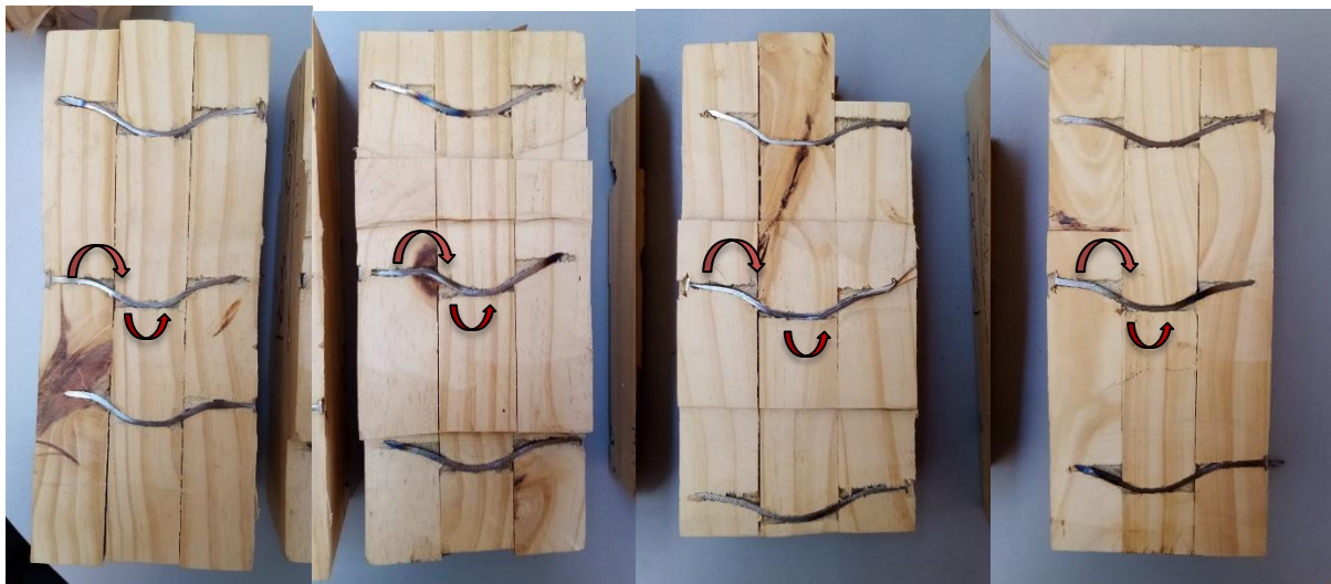
Figura 20. Piezas sometidas a doble cizalle (serie PA35) con deformaciones de los clavos luego de ser ensayados.
