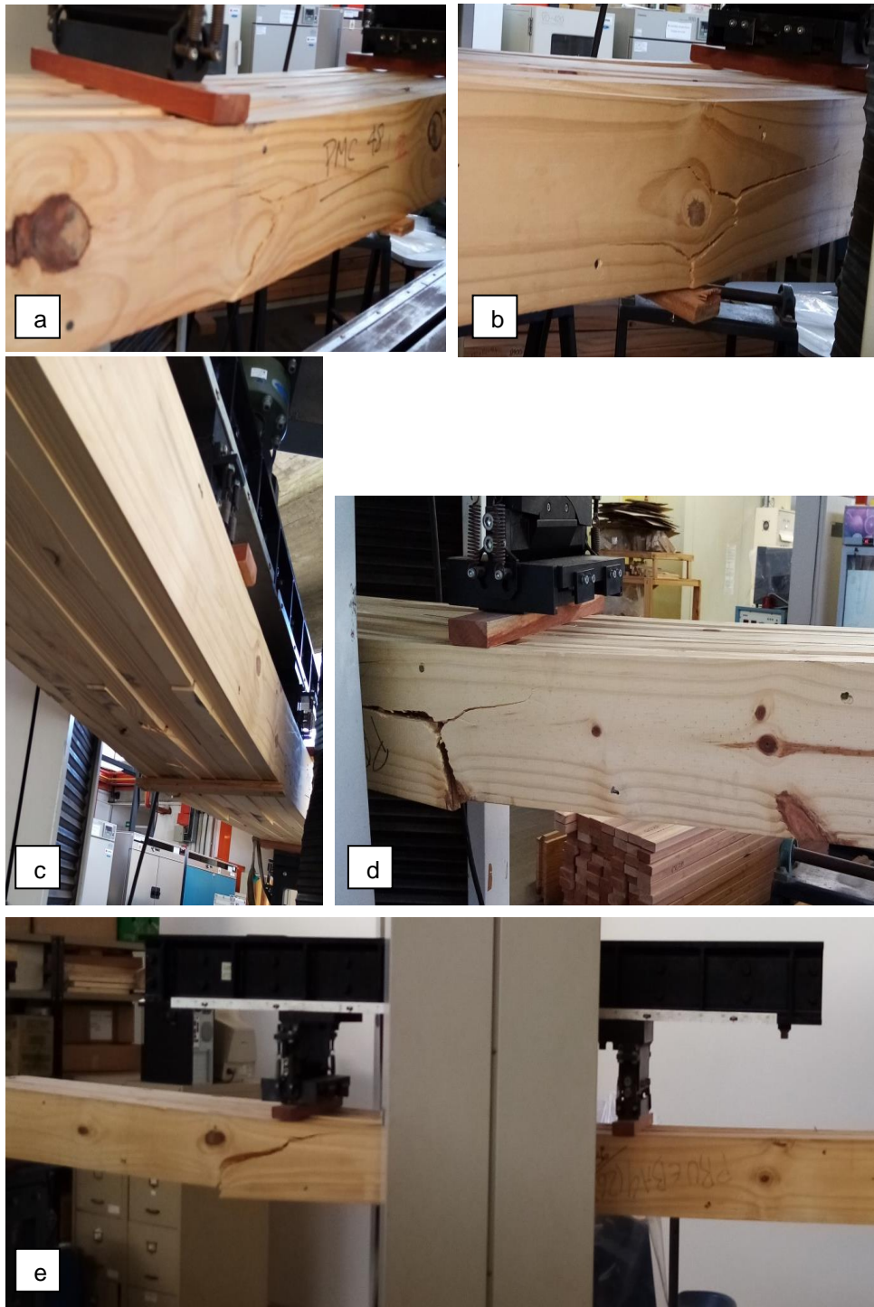
Figura 40. Diferentes modos de rotura de las placas.a) desviación de las fibras, b) y e) presencia de nudo + desviación de las fibras, c) y d), presencia de nudos.
