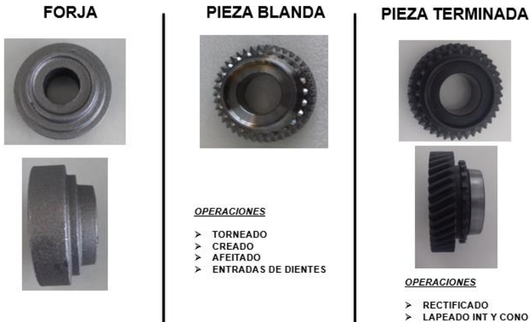
Figura II-28 Transformación Piñón Loco
