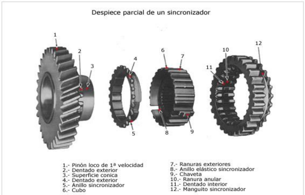
Figura II-36 Conjunto Sincronizador
