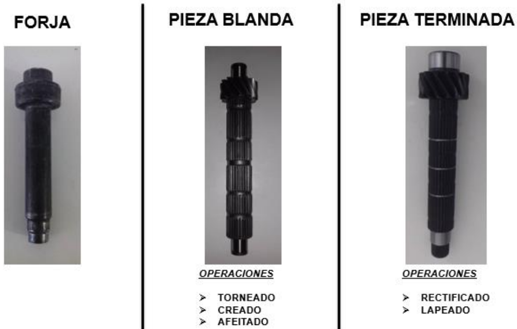
Figura II-31 Transformación Árbol Secundario
