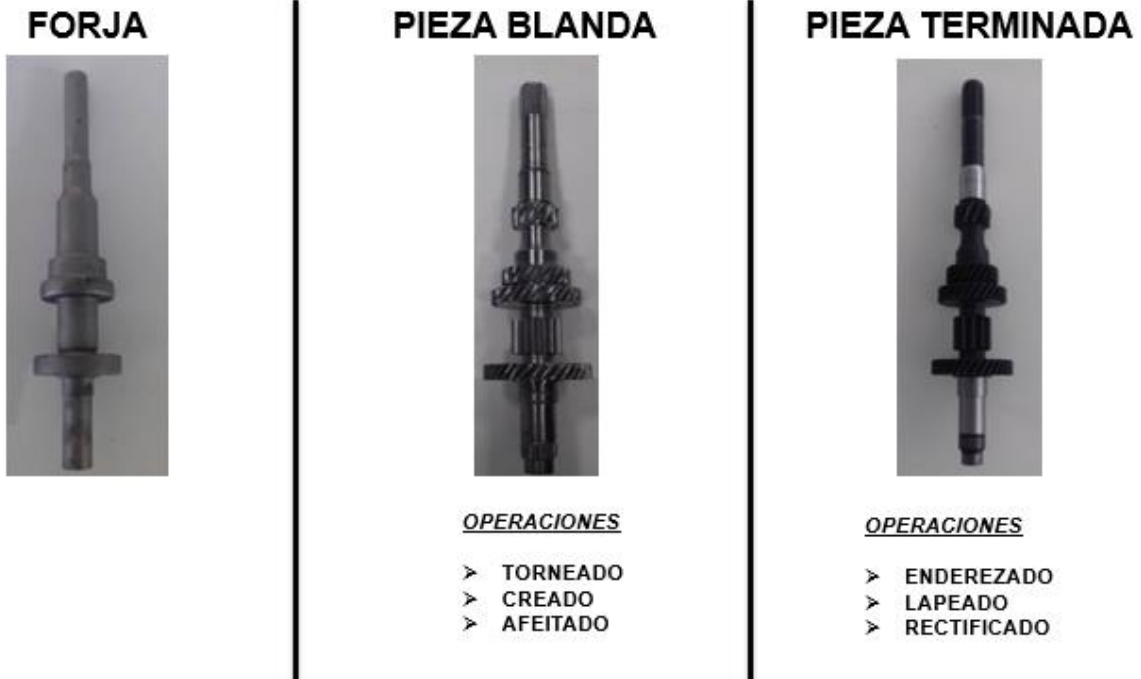
Figura II-30 Transformación Árbol primario
