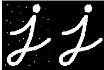
Figura 16: Representación visual del operador de Apertura Morfológica, imagen de la izquierda es la original y la imagen de la derecha es el resultante. Fuente: (OpenCvTeam, 1999)
