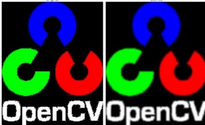
Figura 19: Imagen normal a la izquierda e imagen resultante con el filtro Gaussiano a la derecha. Fuente: (OpenCvTeam, 1999)
