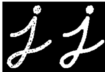
Figura 17: Representación visual del operador de Cerrado Morfológica, imagen de la izquierda es la original y la imagen de la derecha es el resultante. Fuente: (OpenCvTeam, 1999)
