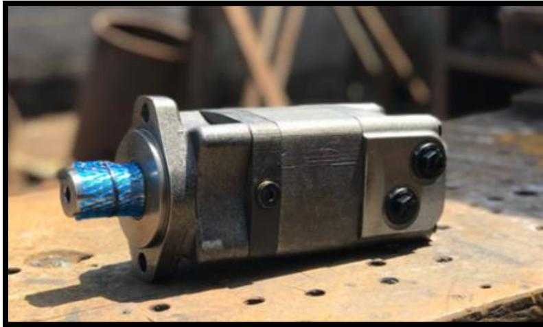
*Ilustración 38: Imagen de Motor hidráulico Char-Lynn serie 10.000 tomada por seminaristas.*
