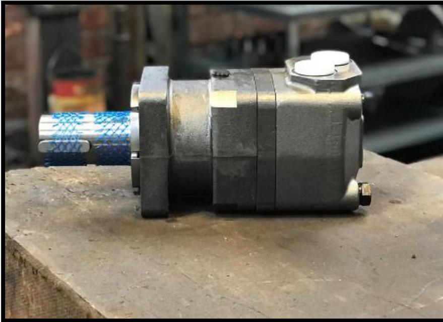
*Ilustración 32: Imagen tomada por seminaristas al motor hidráulico utilizado.*
