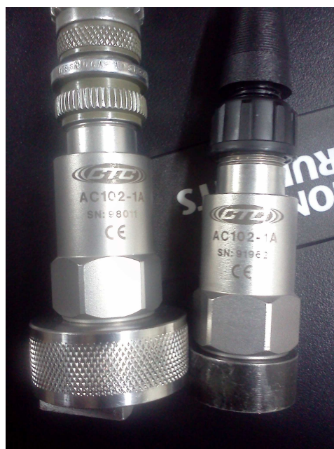
Figura N° 3.7) Acelerómetros modelo AC102-1A, utilizados para medición.
