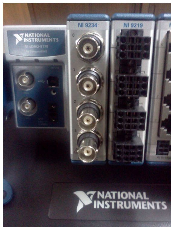
Figura N° 3.8) Tarjeta análogo / digital NI 9234, de National Instruments™.
