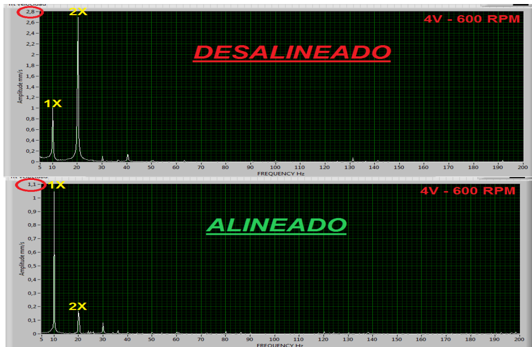
Figura N° 6.2) Comparación de respuesta en frecuencias del punto 4V a 600 rpm.
