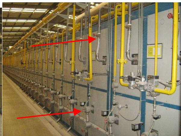
**Figura 3.8** Ubicación de inyectores laterales de aire y quemadores en Módulo de Pre-calentamiento.
