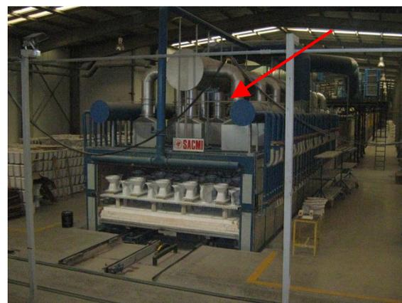
**Figura 3.14** Campanas de aspiración aire de enfriamiento y salida de los productos del Horno.
