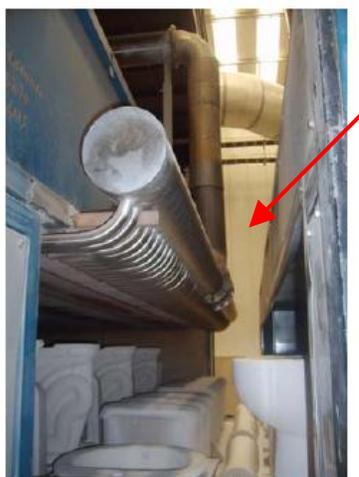
**Figura 3.4** Barrera de aire frío en el Secado.
