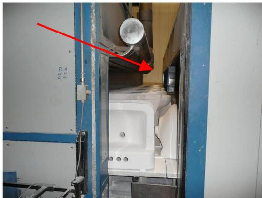
**Figura 3.2** Separación existente entre el Horno y Pre-secado.
