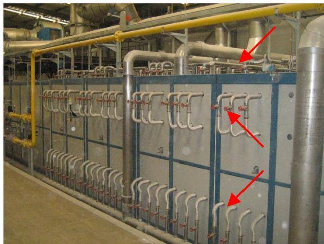
**Figura 3.11** Inyectores inferiores y superiores de aire en Zona de Enfriamiento rápido.
