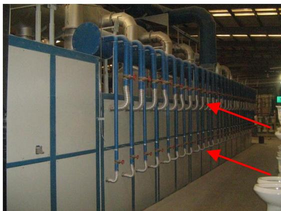
**Figura 3.13** Inyección superior e inferior de aire enfriamiento final.
