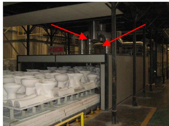
**Figura 3.3** Sistema de circulación aire caliente y extracción de aire húmedo.
