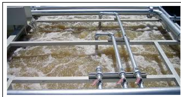
Fig. 1.1 La agitación y el pH correcto permiten la coagulación de los coloides y grasas en el lodo.
