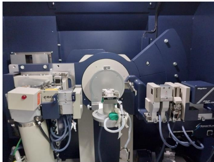
Figura 11 Experimento de microtensión dentro de DRX
