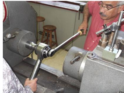
Fig.- 5.2 Calibración de llave de torque. Fig.- 5.3 Verificación de la relación de torque del multiplicador
