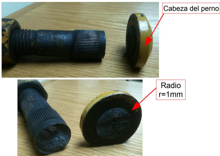
Fig.- 3.5 Perno cortado
