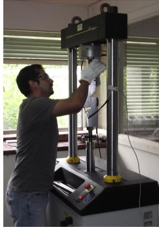
Fig.- 5.6 Montaje de utillaje en la maquina de ensayos
