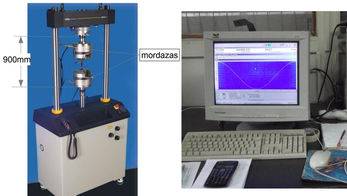
Fig.- 3.14 Máquina de fatiga(izq).Control de la máquina de fatiga(derecha).
