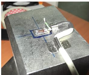
Fig.- 5.1 strain gage montado en el utillaje
