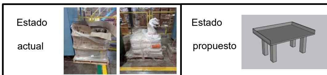
Figura 4.16: Estado actual y propuesto atril para bobinas y sacos de adhesivo
