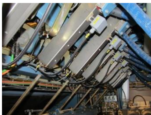
Imagen 2.9: Calefactor de hilos termo fundente
