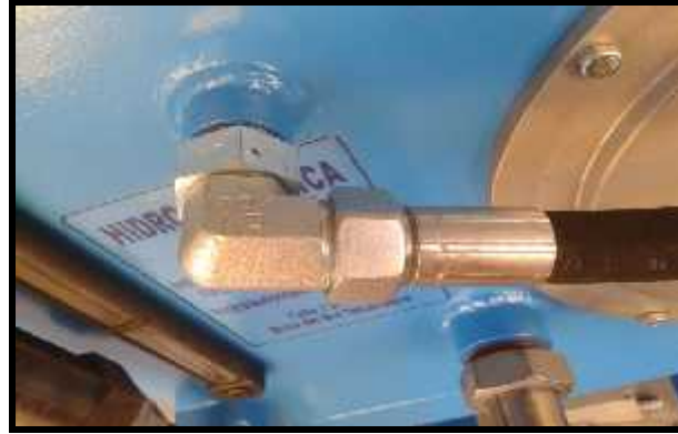
Figura 1.22: Tipo de unión virola a virola.
