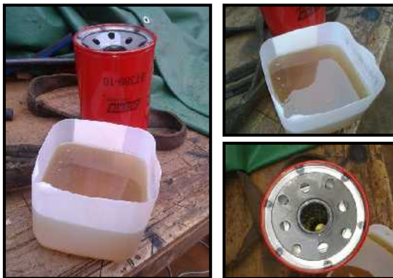
Fig. 7.11: inspección del aceite después del flushing.
