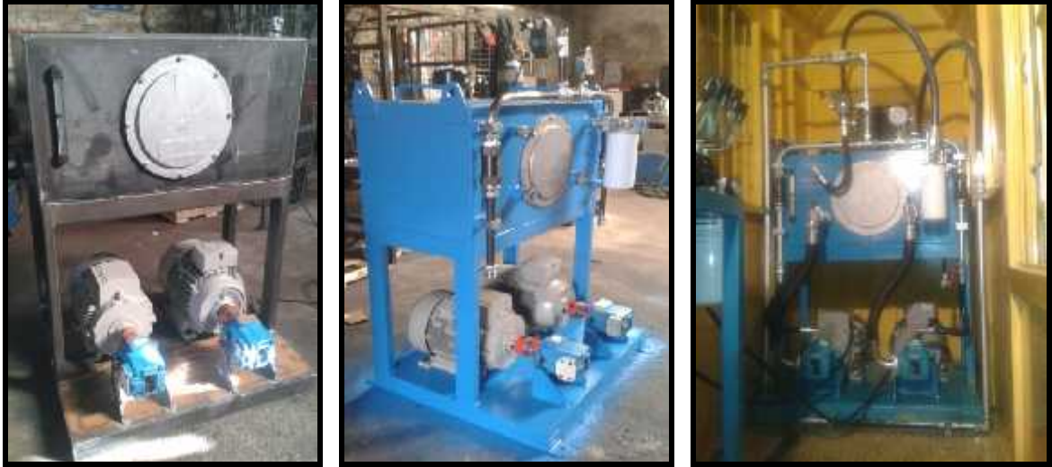
Figura 5.6: Central Oleohidráulica Estanque Tipo L (Etapas).
