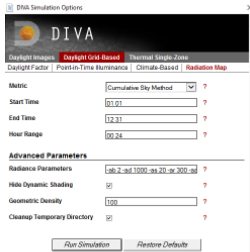
Ilustración 35: ventana de configuración de simulación de radiación. Fuente: elaboración propia.
