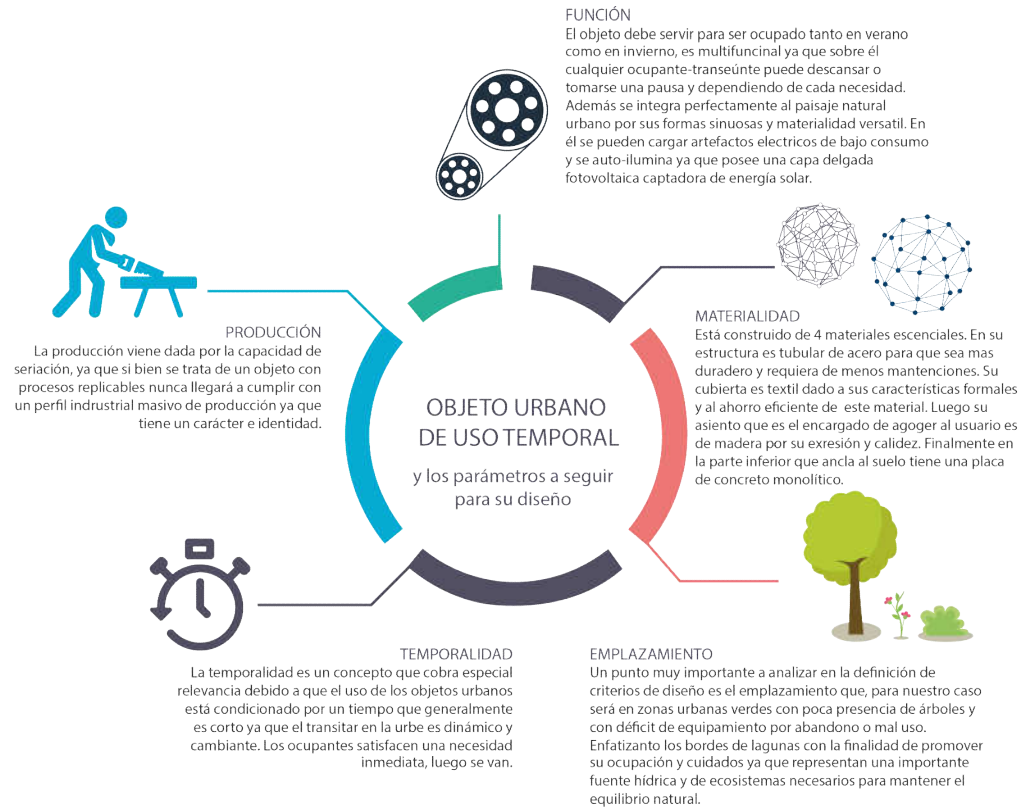
Figura 32: Infografía correspondiente a requerimientos y consideraciones de diseño para un objeto habitable de uso temporal
