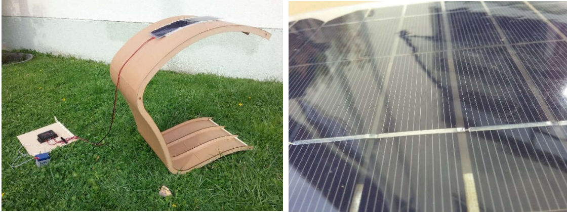
Figura 35: Fotografías correspondientes a primera maqueta con sus respectivos componentes de una instalación off-grid.
