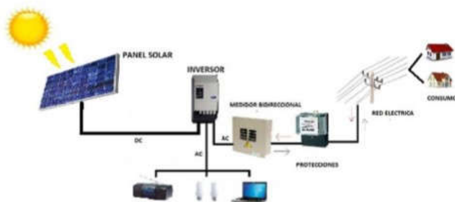
Figura 3: Esquema de un sistema fotovoltaico conectado a la red con sus principales componentes.
