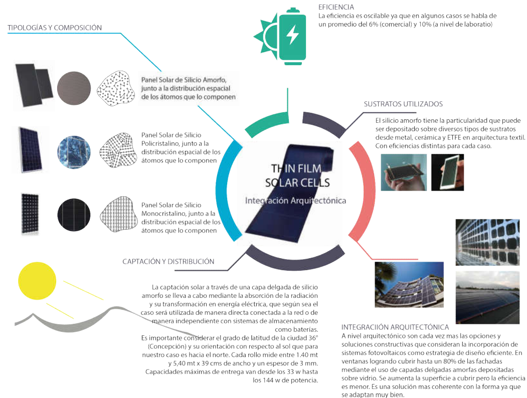
Figura 44: Infografía de una capa delgada fotovoltaica y sus consideraciones de diseño.
