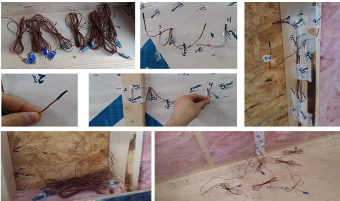
Figura 4.46: Colocación de termocuplas en cubículo de prueba
