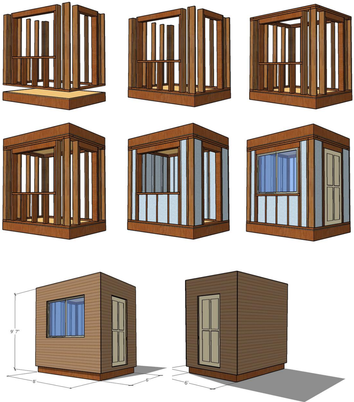
Figura 4.38: Diseño estructural y volumétrico del cubículo de prueba (tabiquería simple de 2"x6")
