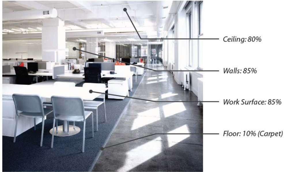
Ilustración 2.1-Terminaciones de las superficies interiores. Fuente: AOE (2011)
