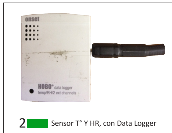
Figura 4.4: Data Logger con Sensor de T° y HR. Marca: Hobo Modelo: U12-013
