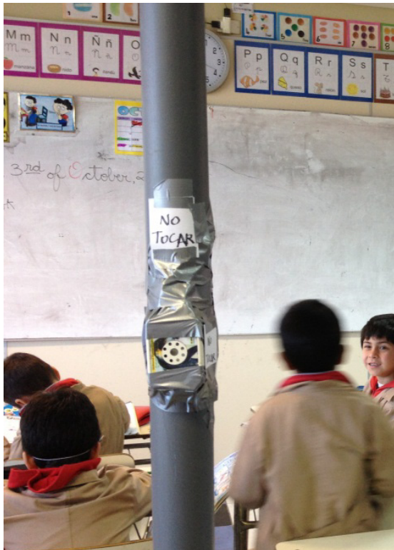
Figura 4.10: Tubo de PVC con los sensores para medir en el interior del aula Caso B.
