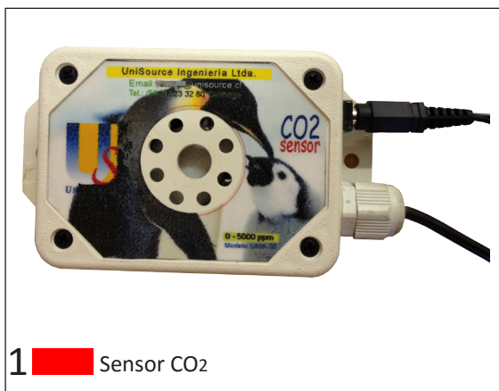
Figura 4.3: Registrador de CO2 Marca: Hobo Modelo: Uni-K30
