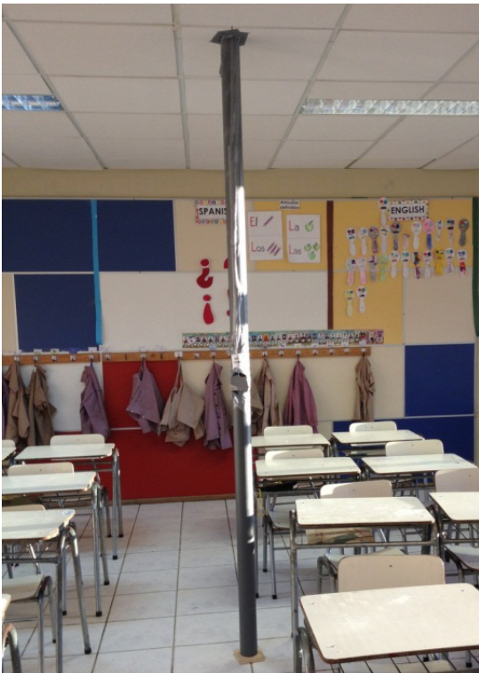
Figura 4.7: Tubo de PVC con los sensores para medir en el interior del aula Caso A.
