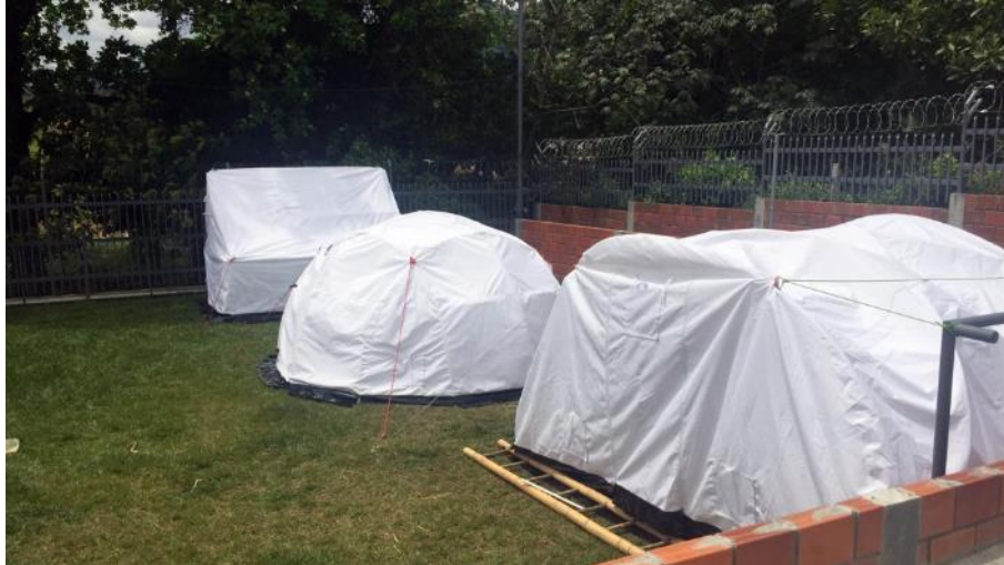
Figura 28 Prototipos instalados en clima cálido en configuración de doble cubierta y ventilación cerrada.
