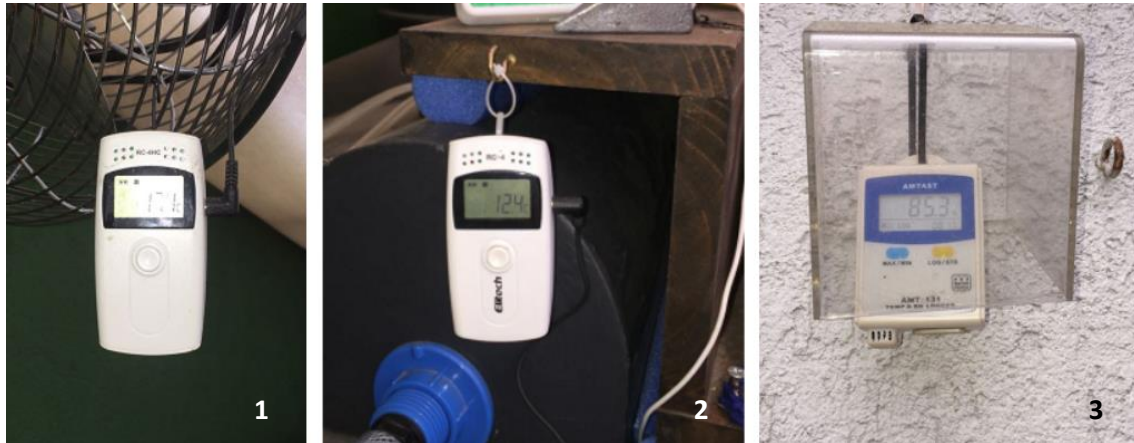
Figura 2.15: Data Logger instalados en el sistema acuapónico construido 1) temperatura y humedad relativa interior, 2) temperatura de agua interior, 3) temperatura y humedad relativa exterior
