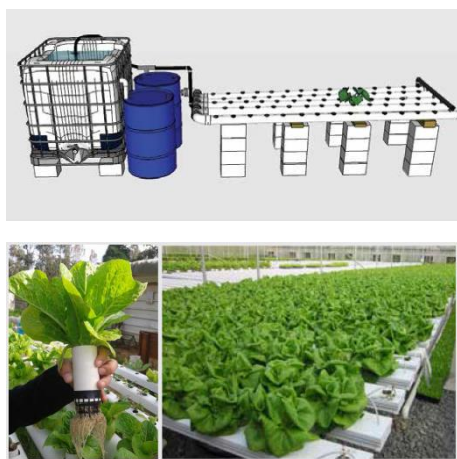
Figura 2.8: Técnica de cultivo acuapónico película de nutrientes
