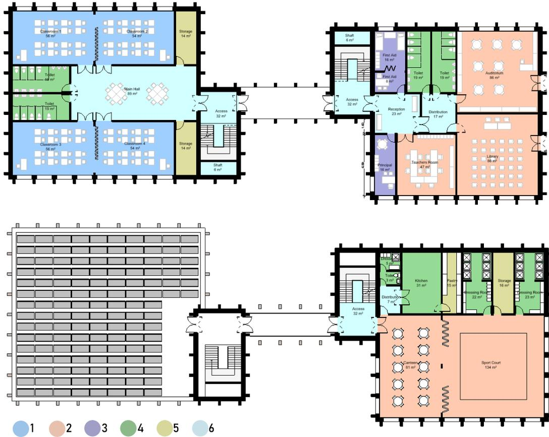
Figura 5.8: Tipologías de recintos para simulación energética (Fuente: elaboración propia)
