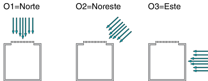
Figura 9. Definición de variables de dirección del viento exterior para las fachadas analizadas con ventilación cruzada.
