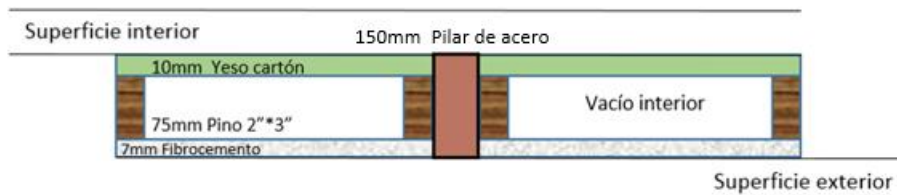
Figura 11: Solución constructiva existente, materialidad muro de aula, escuela Mario Muñoz Silva (Fuente: Elab. Propia).
