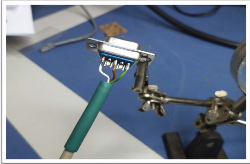
Figura 5.3.2d. Conexión de los cables al extremo hembra del conector DB-9.
