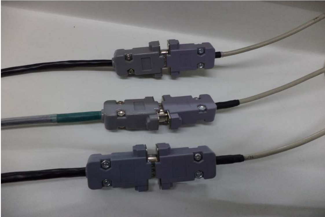
Figura 5.4.1a. Conexión de los cables del Strain Gage al adaptador alternativo.
