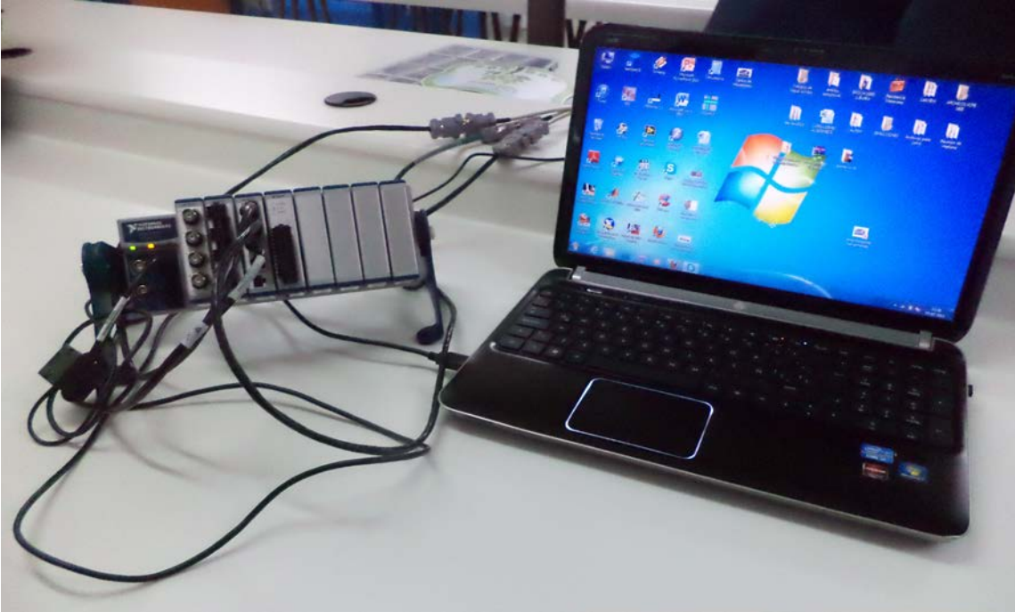
Figura 5.4.2b. Conexión del Chassis cDAQ-9178 al PC.
