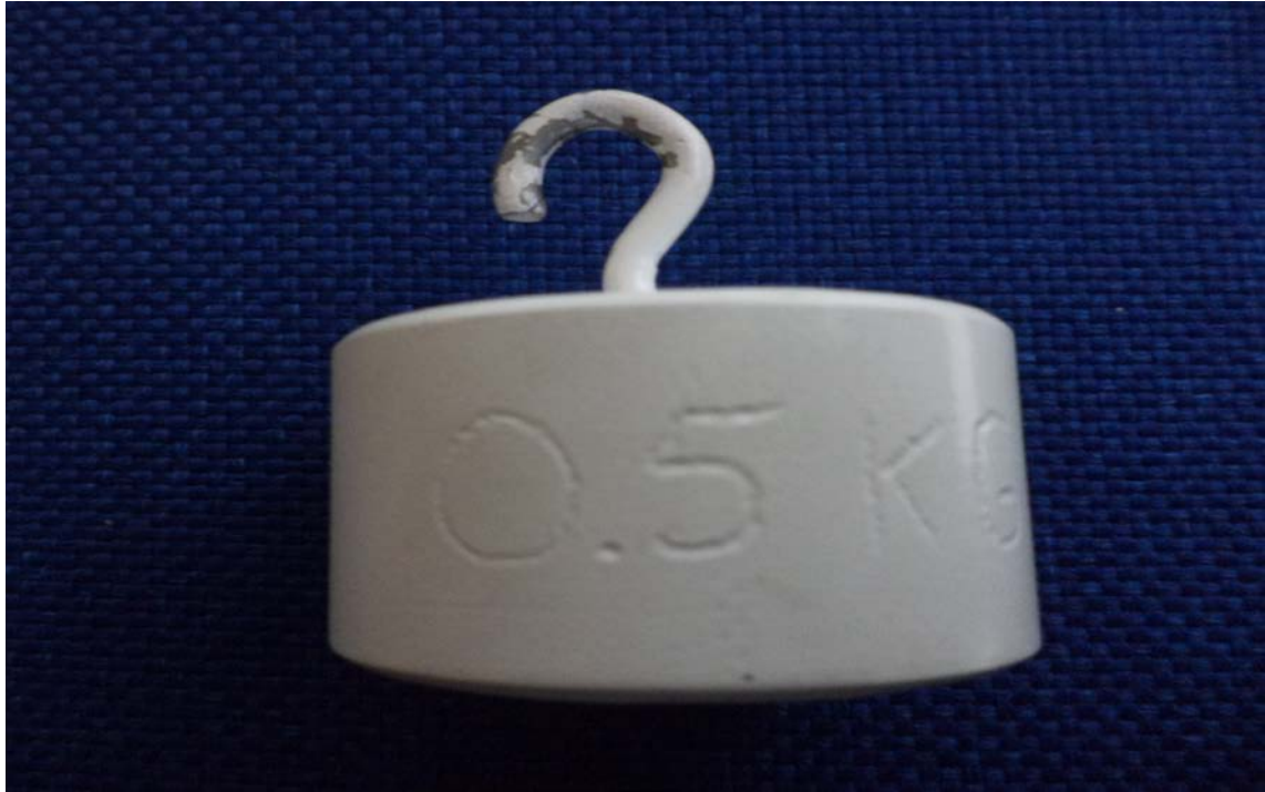
Figura 5.5.3b. Peso o carga aplicada a la barra.
