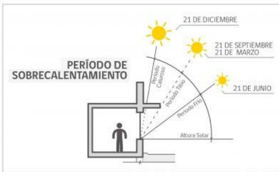
Grafica 16: Muestra la incidencia de sobrecalentamiento a través de protecciones en ventanas.
