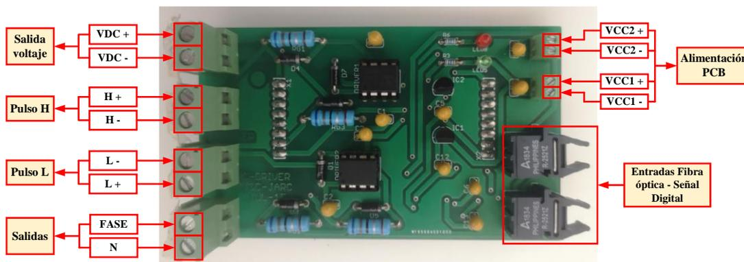
Fig. 5.2 Placa de control con especificaciones físicas.
