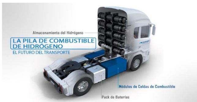
**Figura 3.5.5 “Transporte, particularmente de maquinaria pesada, utilizando módulos de celdas de combustible, El futuro del transporte”**
