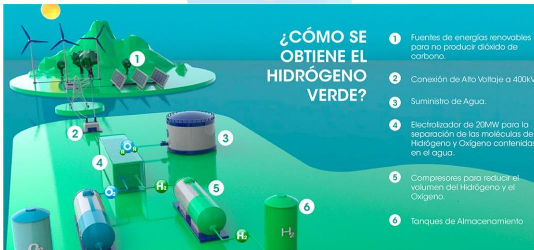
**Figura 3.2.3 “Representación gráfica de la obtención del Hidrógeno verde”**
