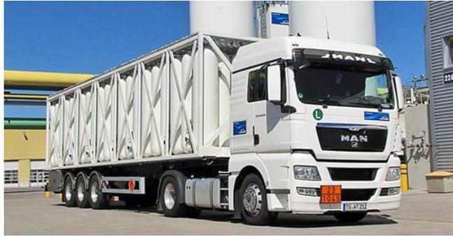
**Figura 3.2.16 “Camión “tube tráiler” vertical, transportador de Hidrógeno comprimido”**
