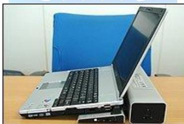
**Figura 3.5.6 “Notebook Toshiba, utilizando pilas de combustible, anunciado para su próxima venta el año 2023”**
